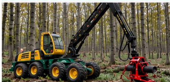
Durchforstung im Buchen-Baumholz mit dem HSM Harvester
